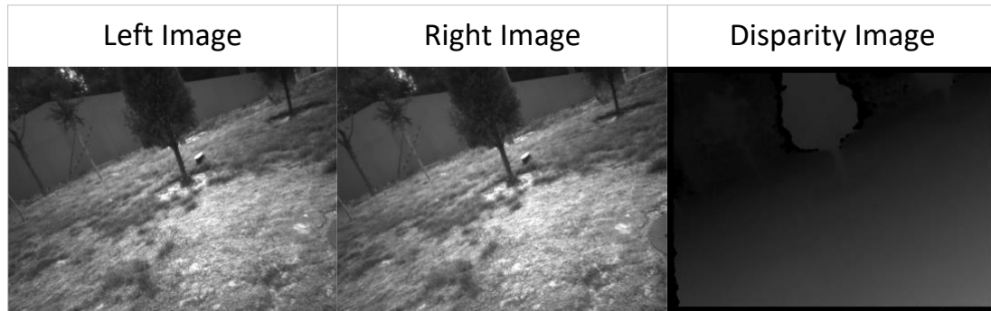
图 6 左右原图和立体匹配后的视差图
